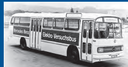
1969 Neubeginn der Hybridentwicklung: der erste Elektro-Versuchsbus vom Typ Mercedes-Benz OE 302 mit hybrider Antriebstechnologie. Der Versuchsbus fährt elektrisch, die notwendigen Batterien lädt ein Dieselmotor.
