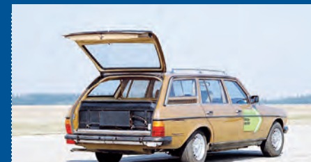
1982 Zu Beginn des Jahres 1982 beginnt Mercedes-Benz mit der Erprobung des Elektroantriebs im Pkw. Der Ladaumzug des E-Klasse T-Modells ist allerdings aufgrund der dort untergebrachten Batterie eingeschränkt.
