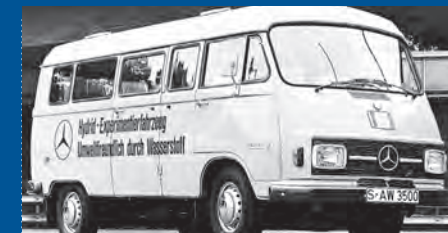
1975 Die ersten Versuchsfahrzeuge mit Wasserstoffantrieb: der Mercedes-Benz Leichttransporter Typ L 307 aus dem Jahr 1975 mit Wasserstoffantrieb und Hybrid-Speicher.
